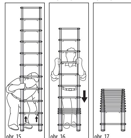
2. Uchopte tretiu priečku odspodu a príslušnú časť úplne vytiahnite smerom nahor (Obr.12, 13, 14), pokračujte štvrtú atď kým nie je rebrík vytiahnutý do požadovanej výšky.
